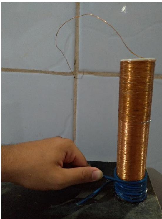
Figura 4 – Fixada a bobina primária na bobina secundária
