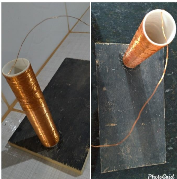
Figura 3 – Cano com cobre fixado na madeira
