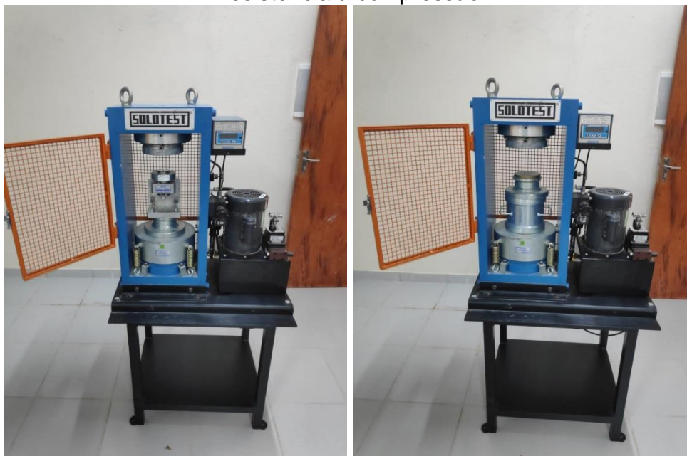
Figura 9 – Instrumentação dos ensaios: (a) Resistência à tração na flexão; (b) Resistência à compressão.
