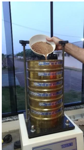
Figura 6: Peneiras e agitador mecânico utilizado
