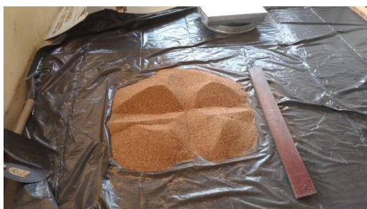
Figura 8: Processo de quarteamento
