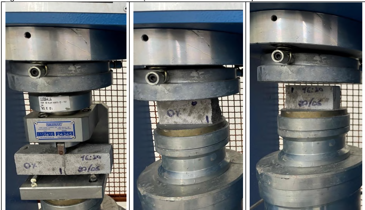
Figura 18 - Ensaio de Resistência à tração na flexão e ensaio de compressão com o mesmo material
