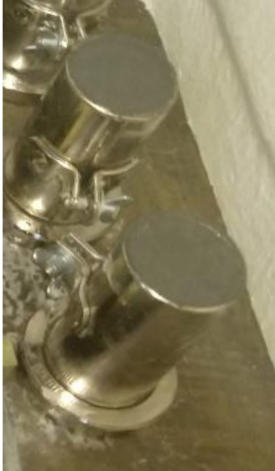
Figura 17 - Molde corpo de prova cilíndrico após se adensado e rasado.
