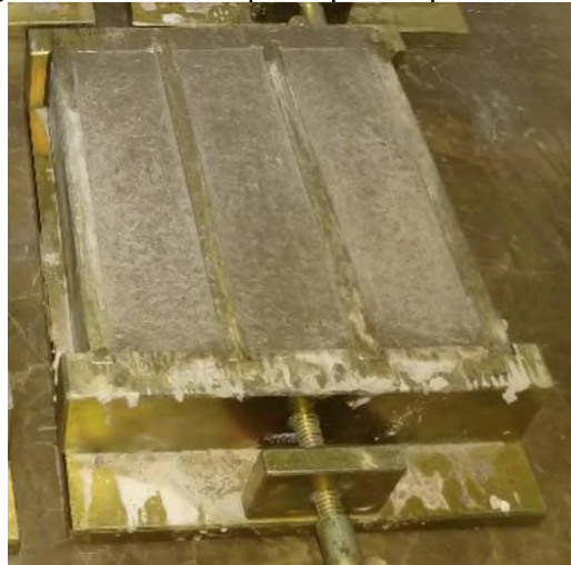
Figura 16 - Molde corpo de prova após ser rasado
