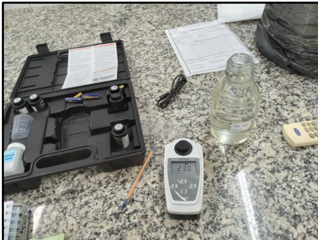
Foto 32: Análise da Turbidez – Equipamento Turbidímetro.
