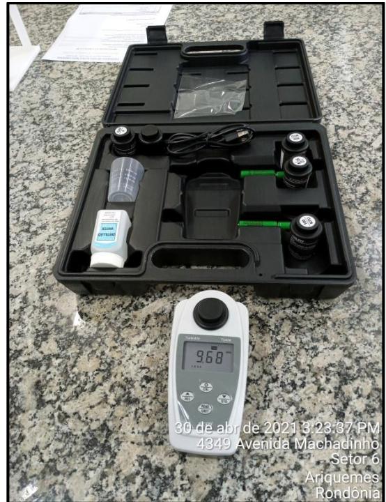
Foto 32: Análise da Turbidez – Equipamento Turbidímetro.
