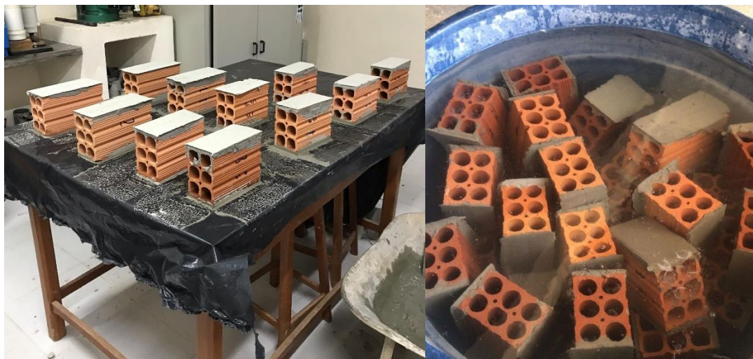
Figura 23 Capeamento das amostras após 24 horas e imersão por 6 horas.
