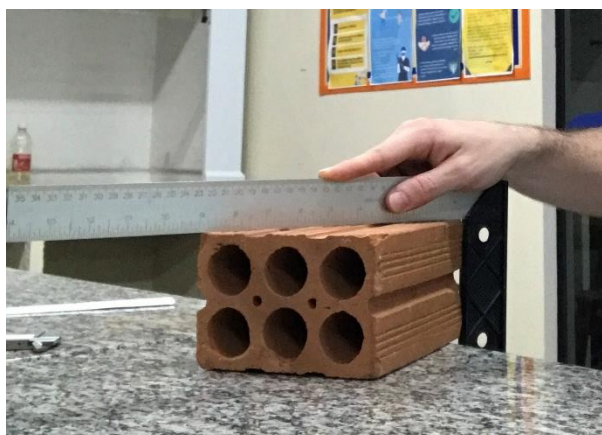
Figura 19 Ilustração de medição no esquadro.
