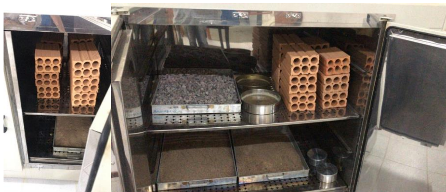
Figura 21 Bloco cerâmico em estufa para secagem.
