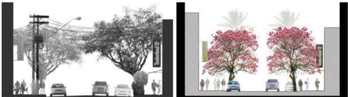
Figura 12: Sistemas de postes e redes aéreas/redes subterrâneas.
