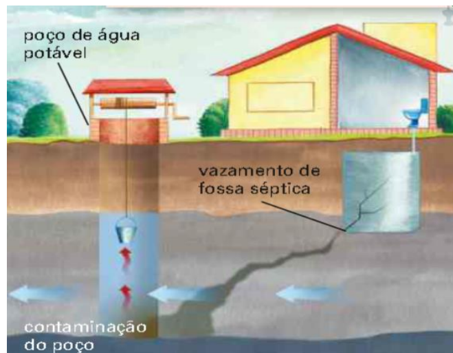
Figura 2 – Contaminação por fossa.
