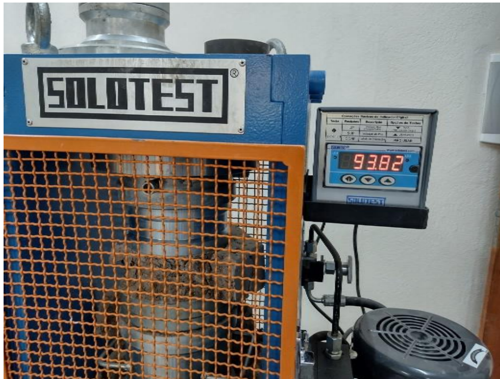
Figura 10 - Ensaio a compressão simples
