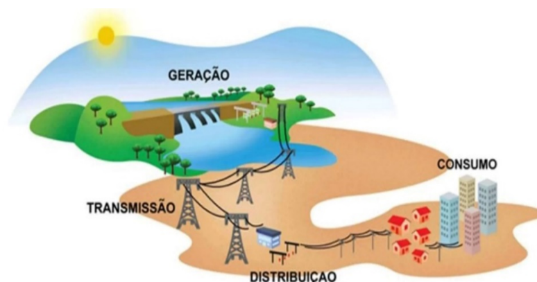
Figura 3 – Sistema de transmissão e distribuição de energia
