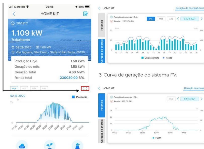
Figura 17 – Aplicativo de monitoramento de geração de energia de um inversor On-grid
