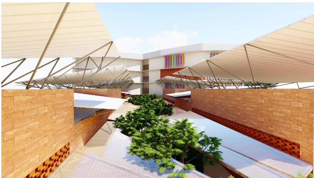
Figura 63 - Telhados termoacústicos, em estrutura metálica.
