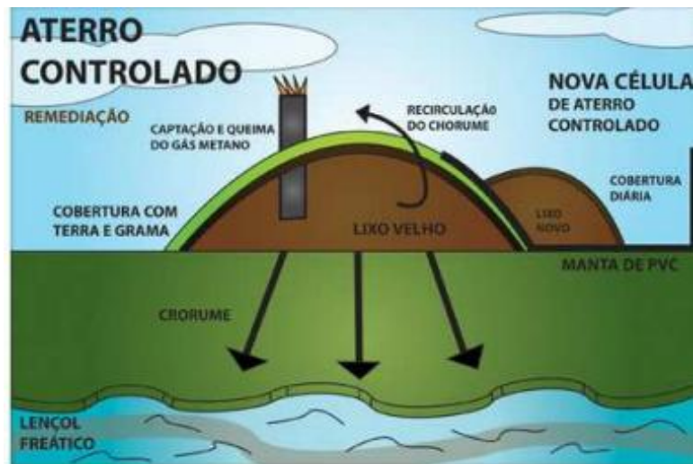
Figura 2: Esquema ilustrativo de um aterro controlado.
