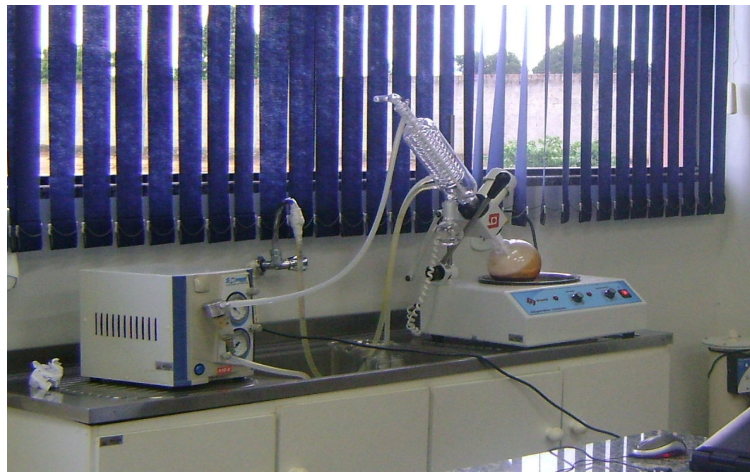
Figura 3 - Rotaevaporação e obtenção do extrato Fonte: Imagem cedida por Neiva Saori Nakamura
