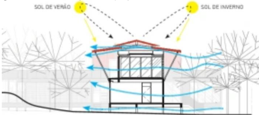
Figura 29 – Casa Campinarana (esquema de funcionamento da cobertura)
