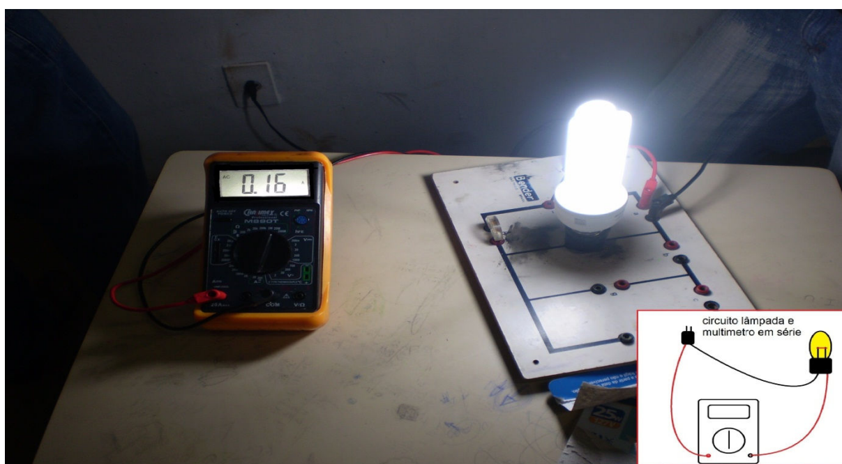
Figura 17. Multímetro ligado em série com uma lâmpada.
