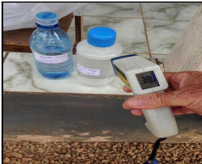
Imagem 03 – Medição da temperatura das amostras
