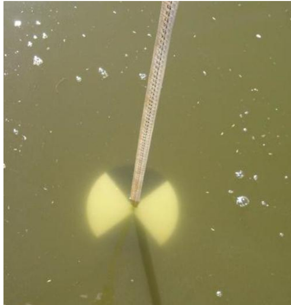
Figura 3 – Imagem do teste com disco de Secchi O disco é colorido em branco e preto, observa-se que preto desaparece de vista. Fonte: Cartilha da Embrapa.
