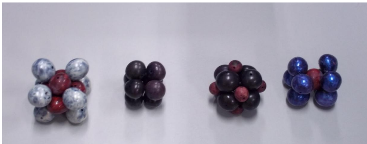
Figura 5 - Celas unitárias e sistema de empacotamento de átomos Fonte: arquivo pessoal do autor
