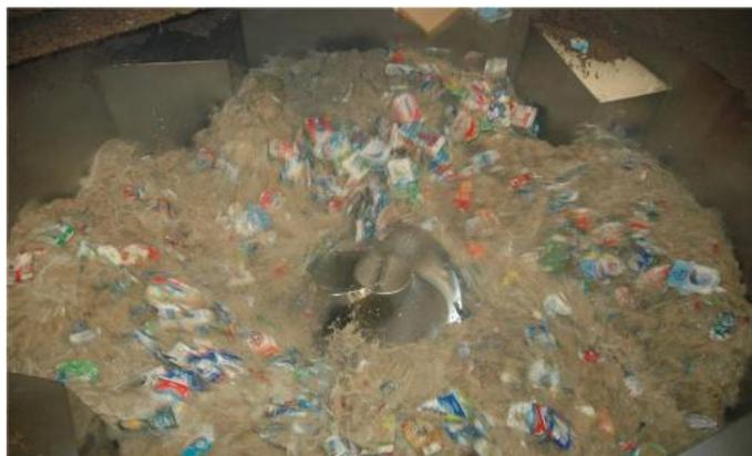
Figura 4 - interior de um HIDRAPULPER.
