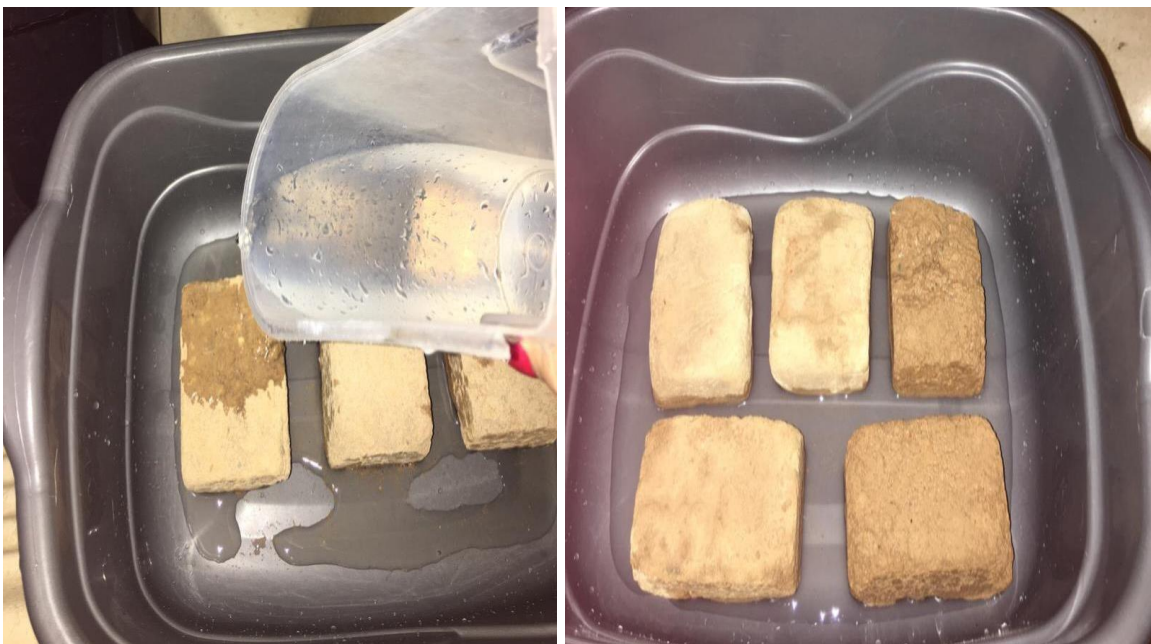
Figura 8 - Processamento de cura dos tijolos
