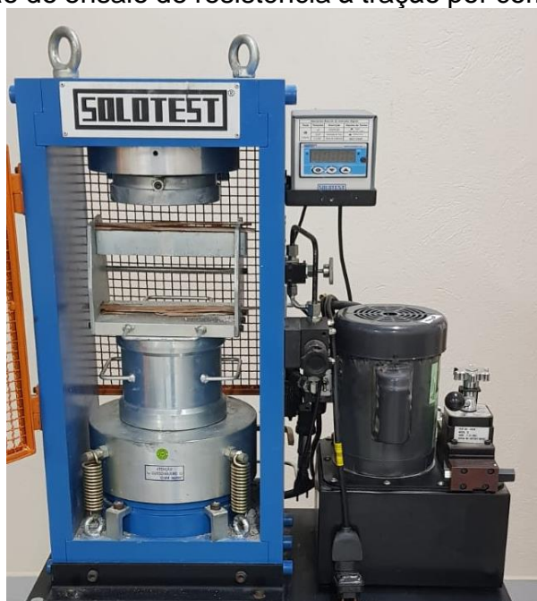
Figura 8 - Instrumentação do ensaio de resistência à tração por compressão diametral
