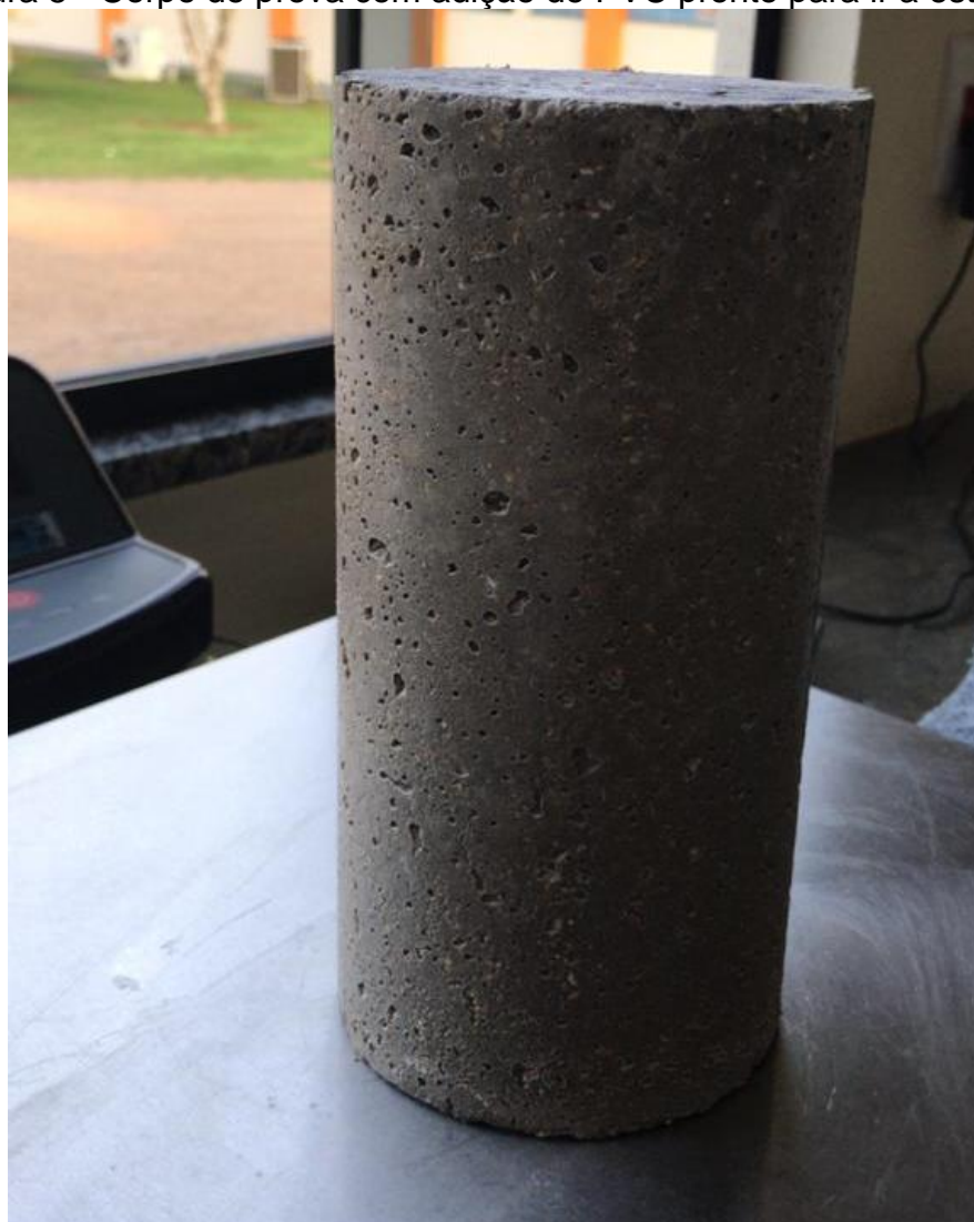
Figura 5 - Corpo de prova com adição de PVC pronto para ir a estufa
