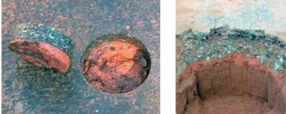
Figura 2 - Exemplo de extração de corpos-de-prova em pavimentos em uso
