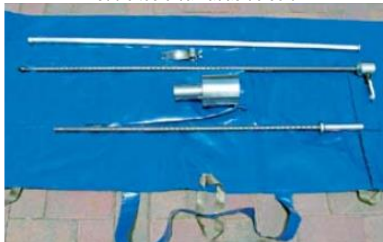
Figura 5 - Exemplo de equipamentos DCP de avaliação estrutural expedita de subleitos e camadas de solo
