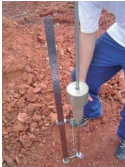
Figura 4 - Exemplo de equipamentos DCP de avaliação estrutural expedita de subleitos e camadas de solo
