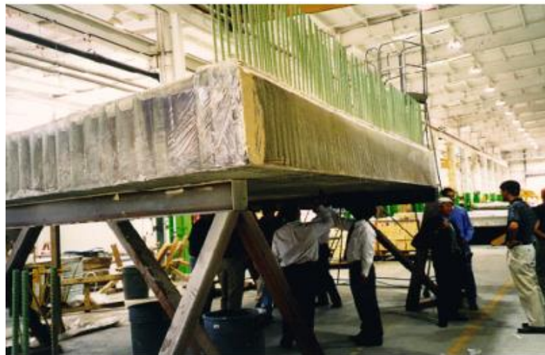
Figura 5 – Fabricação de grande painel honeycomb para ser utilizado como ponte
