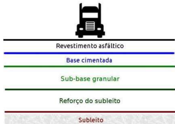
Figura 3 – Ilustração de pavimento semirrígido.
