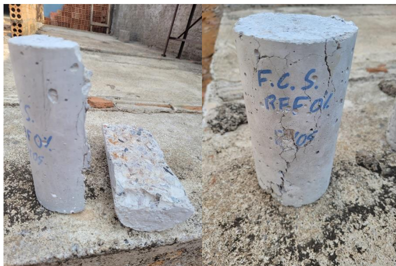
Figura 24: Comportamento do concreto pós fissuração sem adição de fibras de aço.
