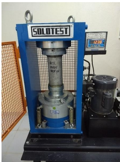
Figura 22: Rompimento do corpo de prova.
