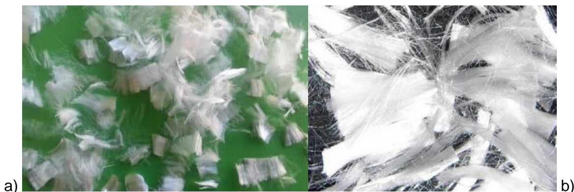
Figura 3: Fibra sintética de polipropileno (a) microfibras (b) macrofibras.
