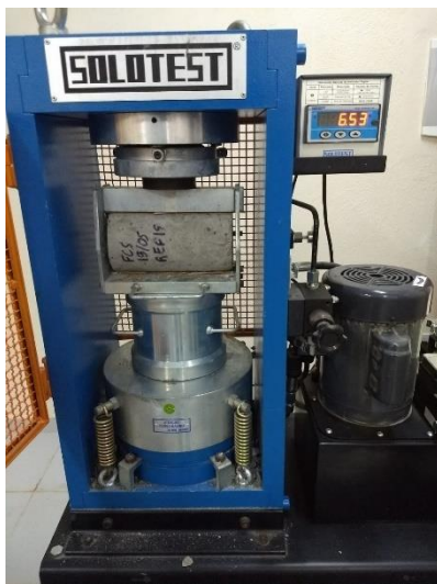
Figura 23: Rompimento do corpo de prova.
