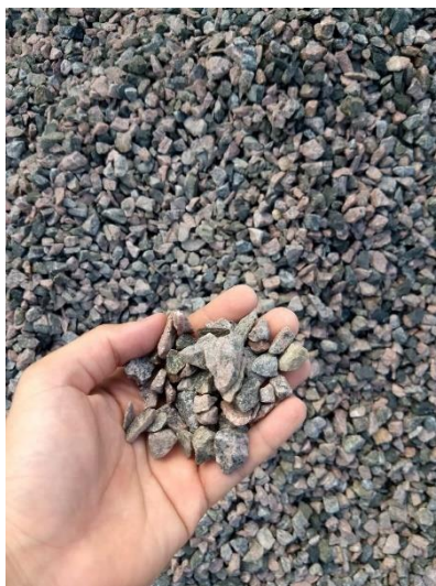
Figura 10: Agregado graúdo úmido.
