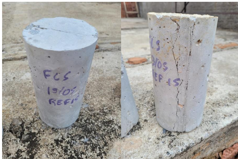
Figura 25: Comportamento do concreto pós fissuração com adição de fibras de aço.
