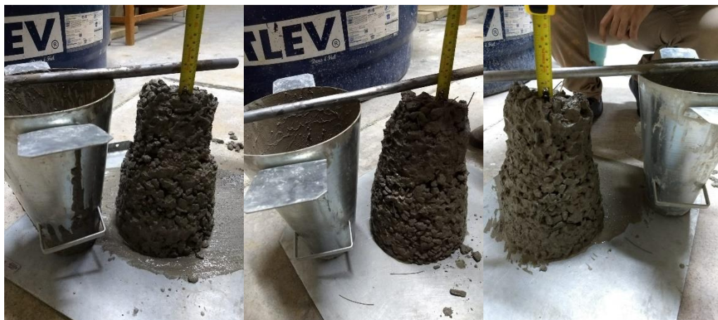
Figura 21: Abatimento do tronco de cone.
