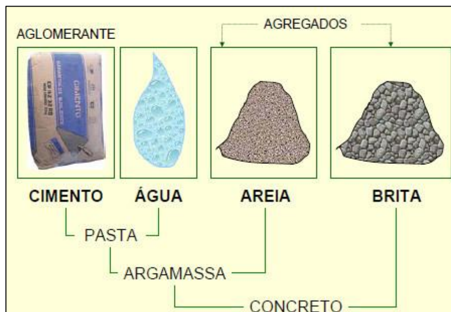
Figura 2 – Composição do concreto
