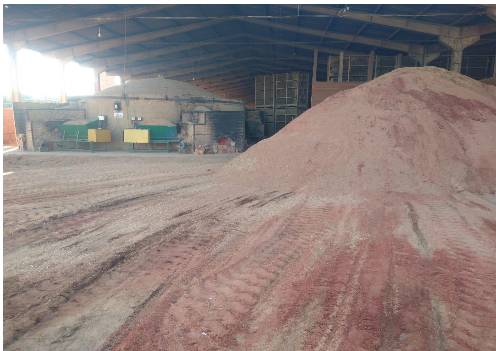
Figura 6 – Insumos para a fabricação de tijolos vermelhos – (pó de serra)
