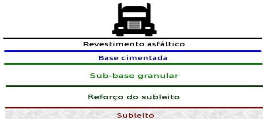
Figura 3 - Estrutura do Pavimento Semirrígido (semi-flexível)
