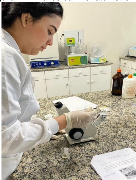
Figura 7 – Análise com refratômetro Abbé
