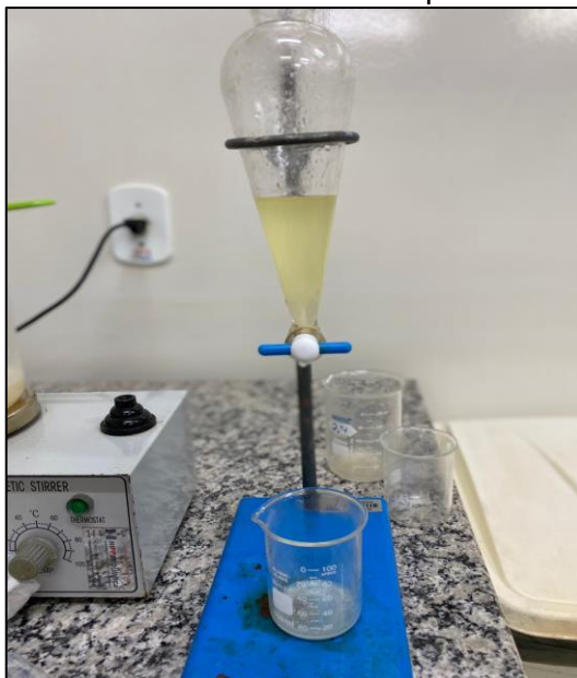
Figura 4 - Óleo da castanha extraído por Arraste a Vapor
