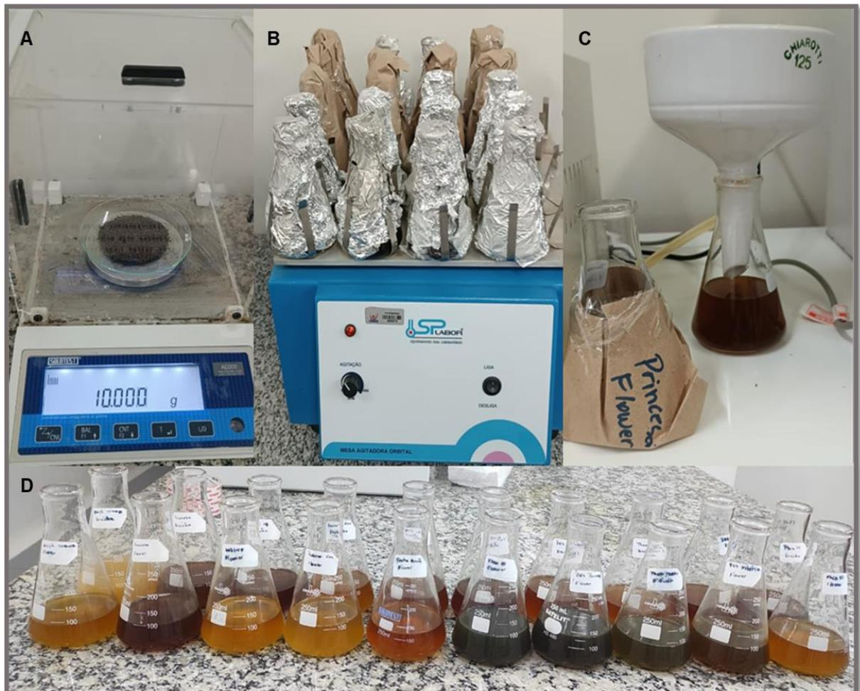
**\*A:** Pesagem da amostra; **B:** Maceração por agitação; **C:** Filtração da amostra por filtro à vácuo; **D:** Extratos filtrados prontos para evaporação em banho-maria.
