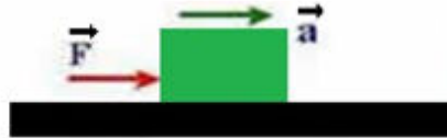
Figura 4: aceleração em função da força, o vetor \vec{F} é a força aplicada e o vetor \vec{a} a aceleração resultante.
