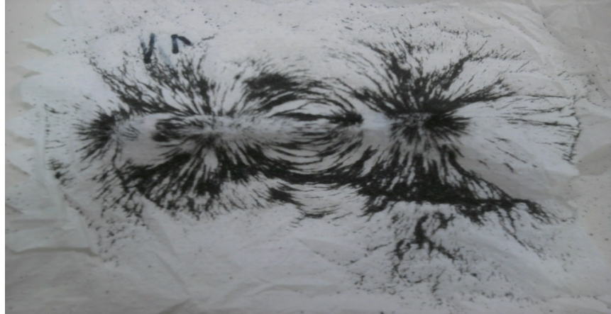
Figura 5 - Mapeamento do Campo Magnético Fonte: Próprio autor
